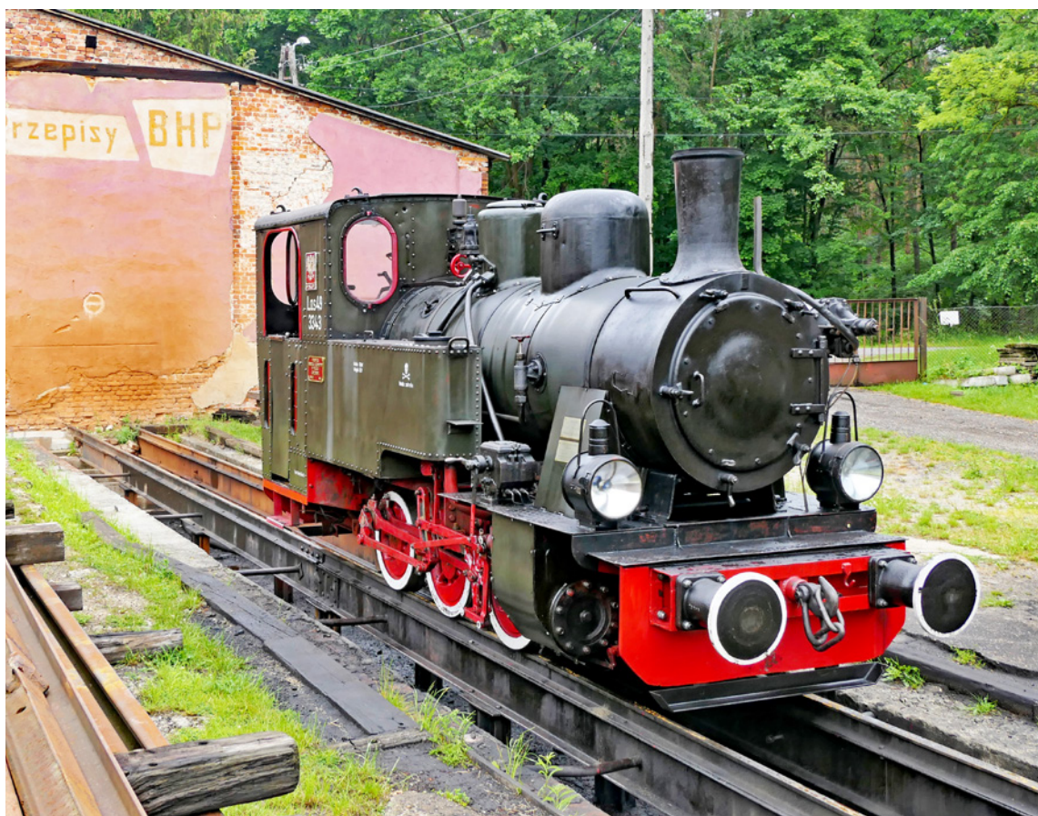
◀ Die Dampflokomotiven vom Typ Las wurde in den Jahren 1947 bis 1948 von der Lokomotivfabrik Fablok in Chrzanów gebaut. Diese Las läuft auf 785 mm-Spur bei der Rudy Kolejka Wąskotorowa.
